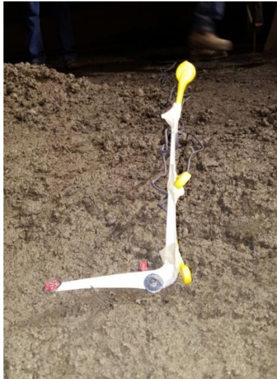
Figura 67. Profundidad de los sensores
