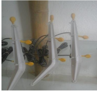
Figura 63. Ménsula para sostener Sensores Command Center
