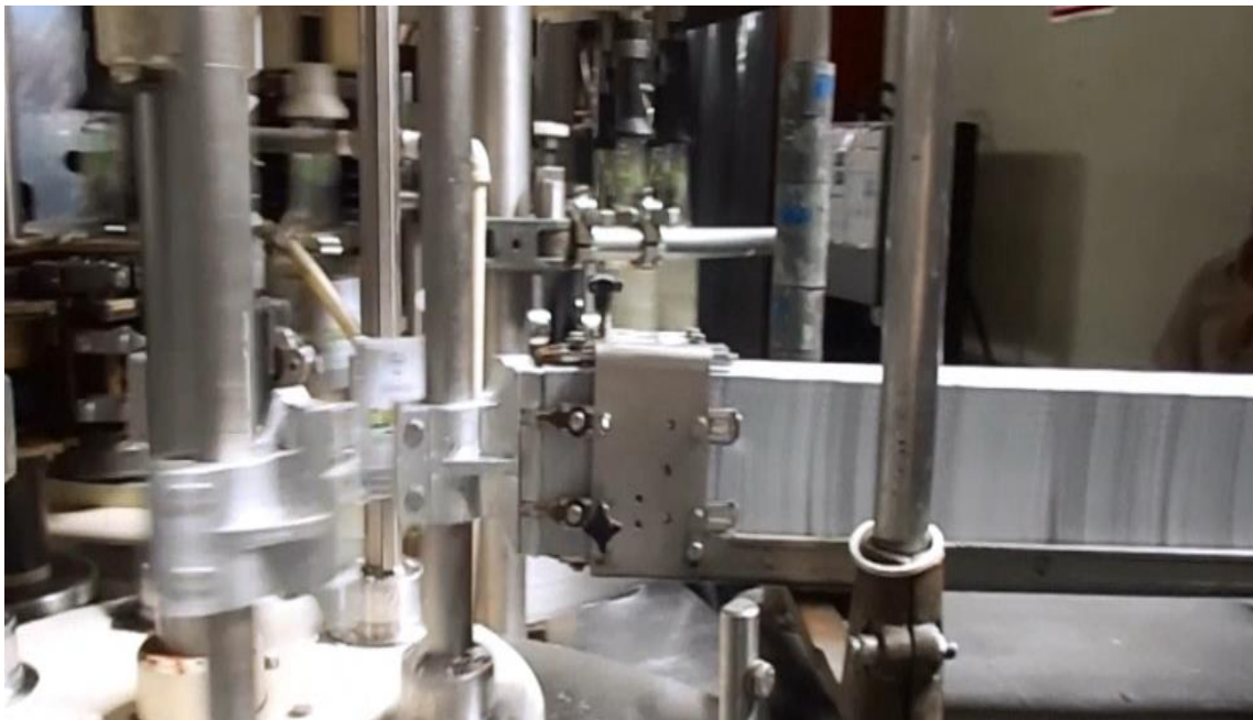
Figura 24. Etiquetadora - línea 1 de envasado
