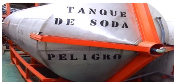
Figura 41. Tanque de soda cáustica
