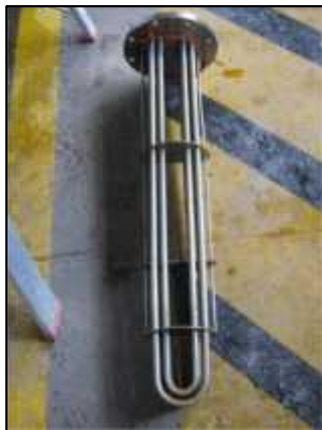
Espejo del ICCT2 y los 20 tubos con deflectores
