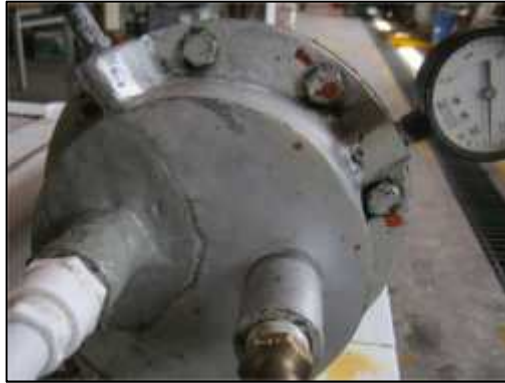
Cabezal del ICCT1 no pasa la prueba hidrostática
