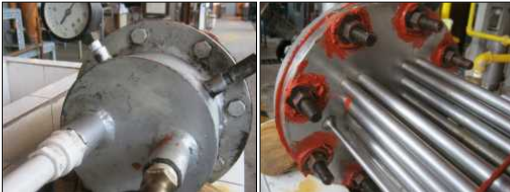
Cabezal del ICCT1 no pasa la prueba hidrostática
