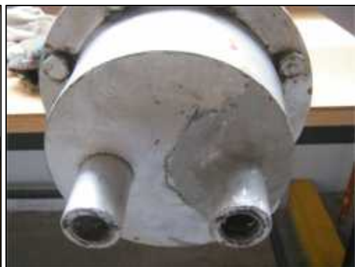
Aplicación de resina Epoxy
