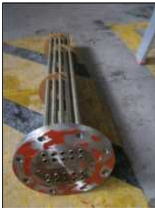
Espejo del ICCT2 y los 20 tubos con deflectores
