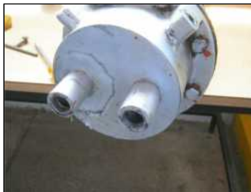
Raspado de pintura en el área de fuga
