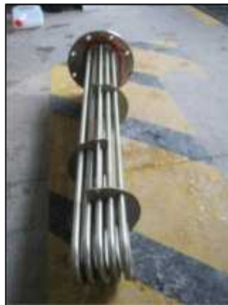
Espejo del ICCT2 y los 20 tubos con deflectores
