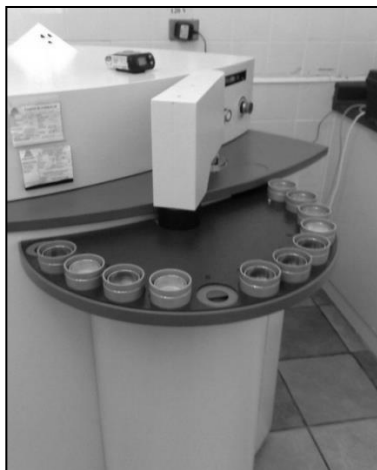
Figura 15. ARL (Equipo de medición de concentración química porcentual por fluorescencia de rayos X)
