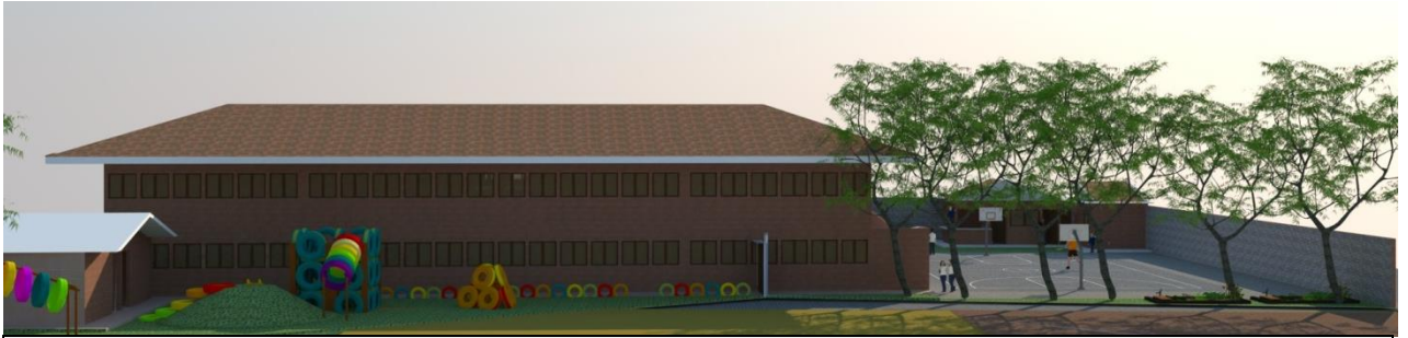
Fachada Norte que aprovecha la incidencia del sol hacia las aulas
