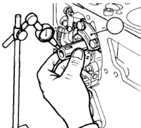
Figura 36. Luz o juego axial del eje de levas
