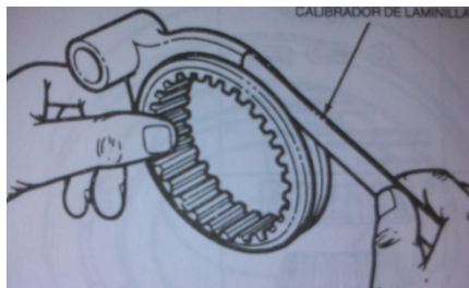
Figura 57. Inspección de horquilla de cambio
