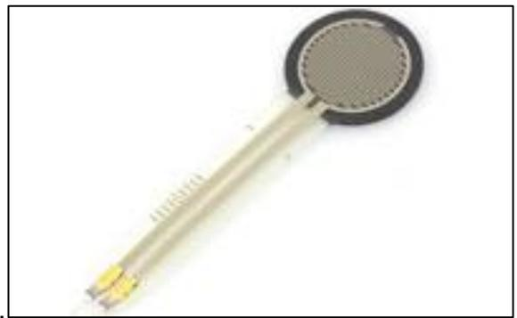
Fuente: Canada Robotix. *Interlink force sensing resistor 402 FSR (0,5" Circle)*. <http://www.canadarobotix.com/force-sensors/interlink-fsr-402>. Consulta: 19 de marzo de 2017.
