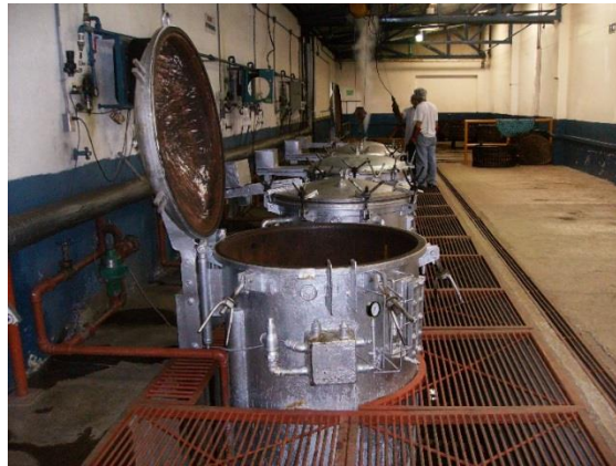
Figura 44. Autoclaves verticales estacionarias utilizadas en el proceso térmico
