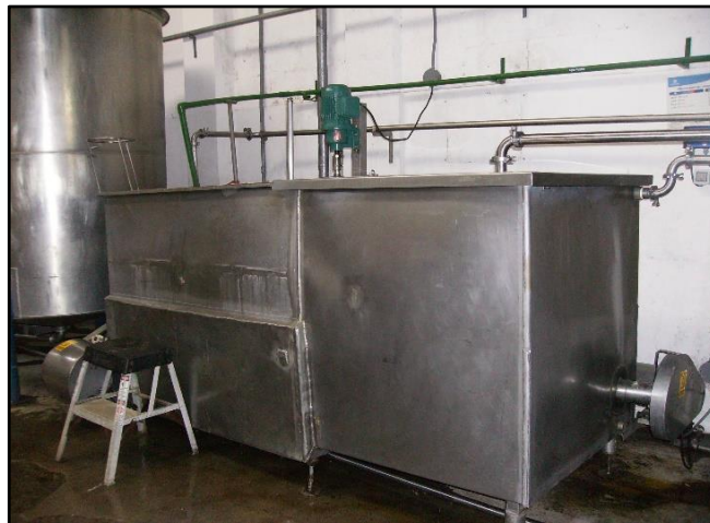
Figura 12. Tanque de mezcla rectangular
