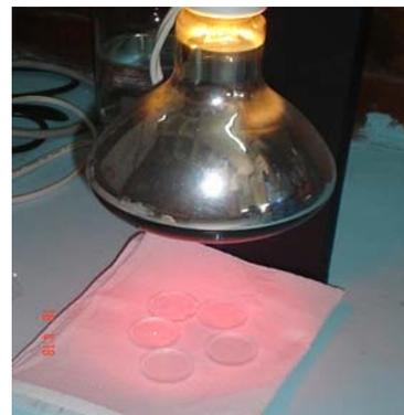
**Figura 20. Lámpara UV. proceso de secado de los reflectores conteniendo la muestra a analizar**
