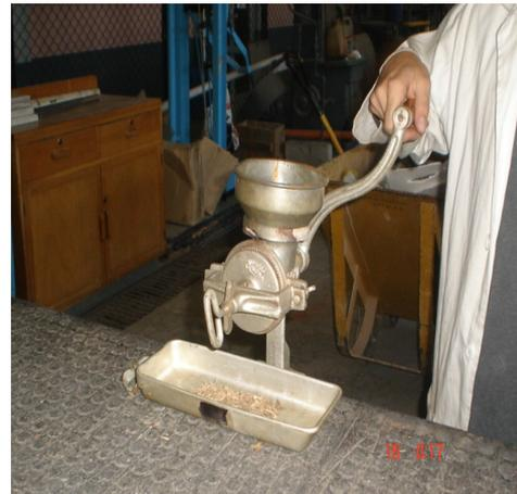
**Fig. 14. Molienda de las diferentes fracciones de las macrófitas.**
