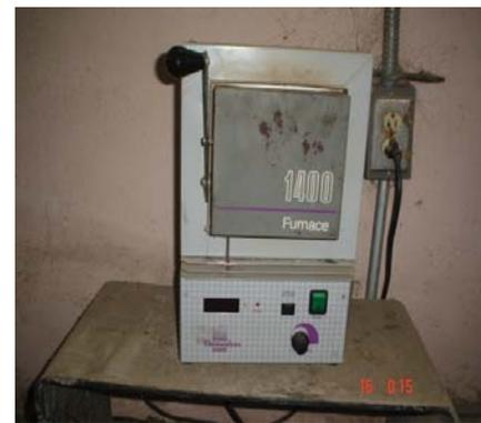
Figura 17. Mufla donde se llevaron las calcinaciones de la muestra a 1000oC durante 2.5 horas
