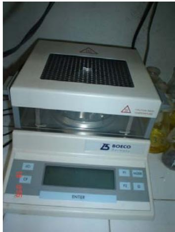
**Fig.13. Balanza de humedad**
