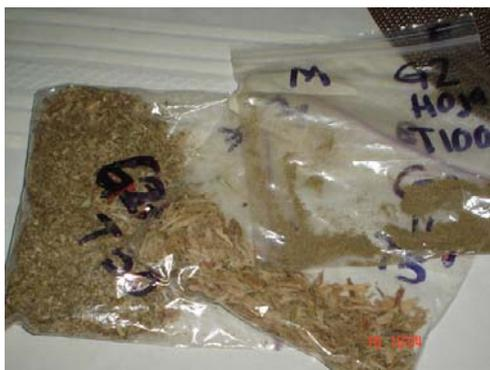
Figura 15. Muestras de jacinto acuático y tul, molidas e identificadas por sección de la planta.
