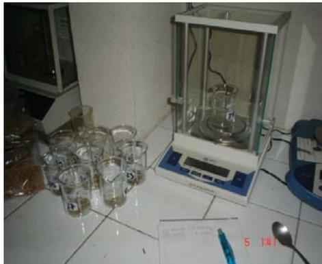
Figura. 16 Determinación de pesos de las diferentes fracciones de la muestra cabo
