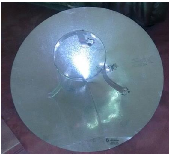
Figura 22. Paraboloide de la estufa solar elaborado con lámina galvanizada
