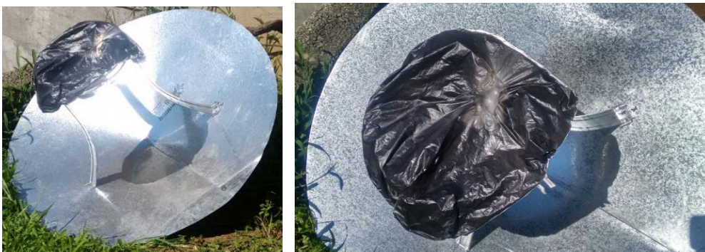
Figura 26. Prueba experimental del punto focal, con una bolsa plástica
