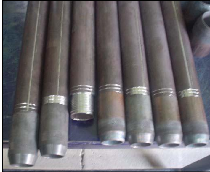
Figura 33. Penetrómetro muestreador estándar y tubería de muestreo
