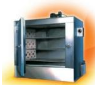
Figura 53. Equipo a utilizarse en el porcentaje de humedad
