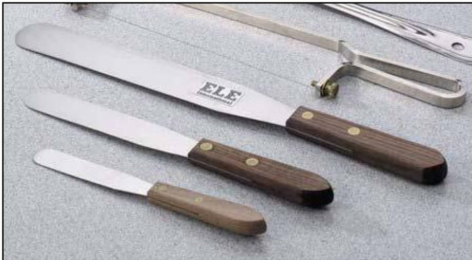
Figura 38. Espátula con hoja flexible para alisar la muestra en la copa
