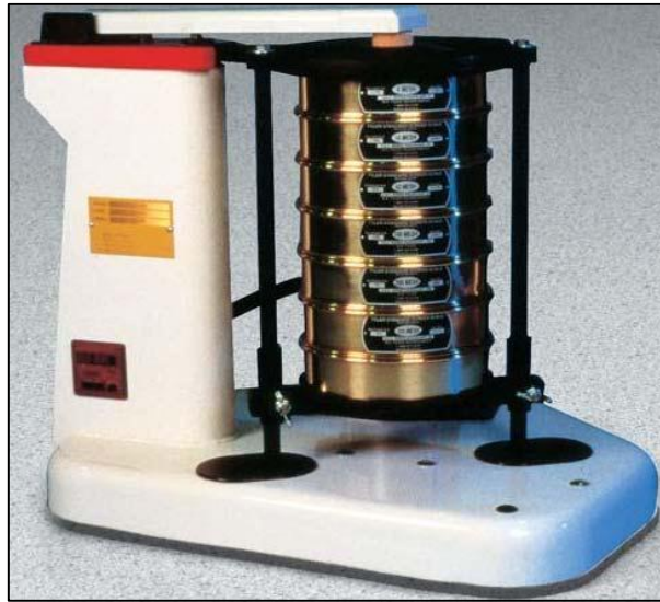
Figura 42. Máquina tamizadora con juego de tamices
