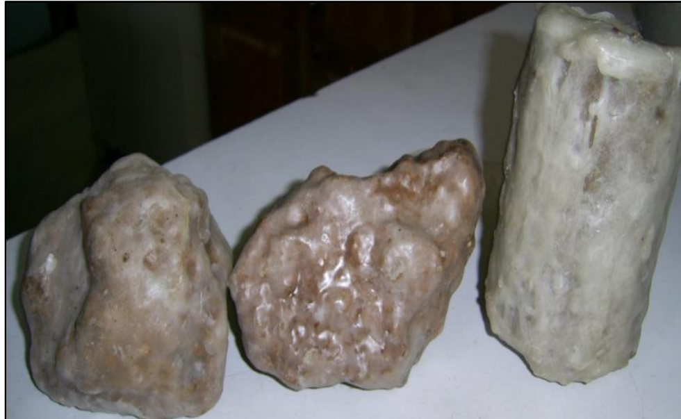
Figura 52. Especímenes de muestras inalteradas, para determinar el peso específico del suelo
