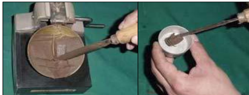
(d) Muestra para contenido de humedad tomada de la zona de cierre de la ranura
