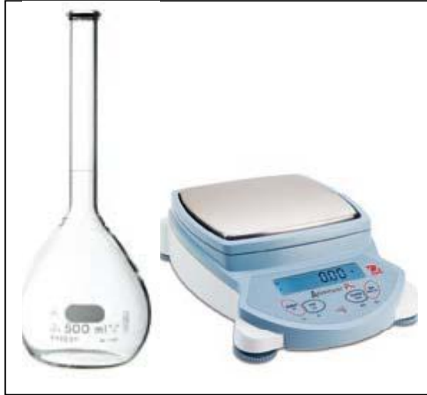
Figura 50. Equipo para determinación de la gravedad específica del suelo
