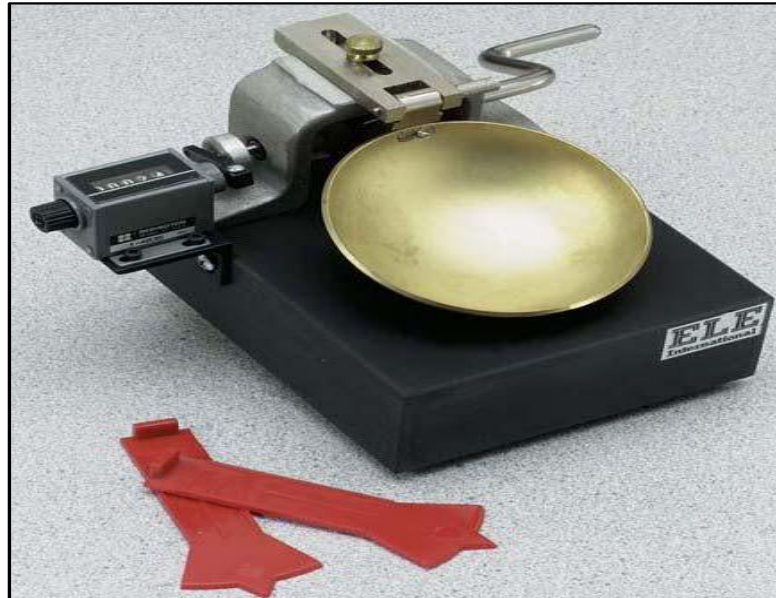
Figura 35. Copa de Casagrande ASTM D4318
