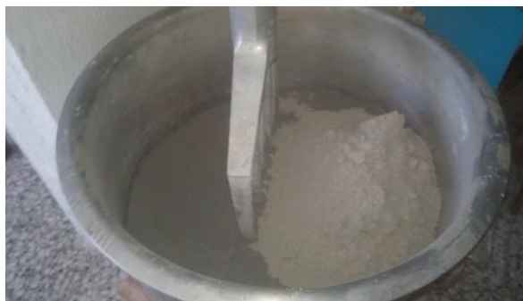
Figura 17. Proceso de homogenización de ceniza y cemento
