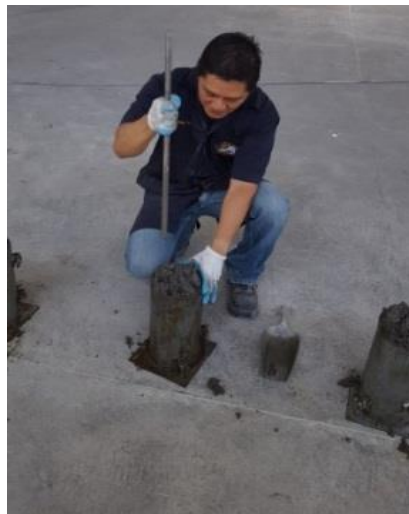
Figura 27. Elaboración de especímenes cilíndricos de concreto
