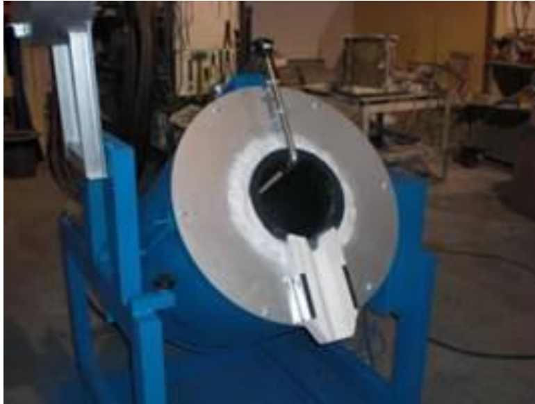
Figura 14. Horno de crisol basculante
