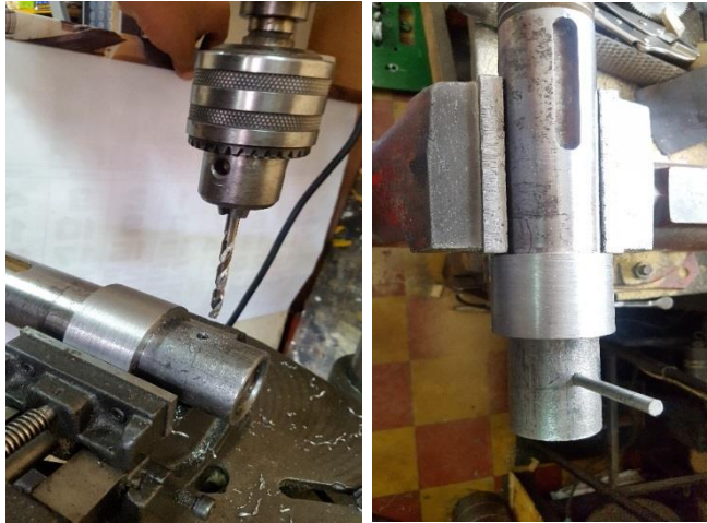
Figura 37. Introducción de pin de seguridad
