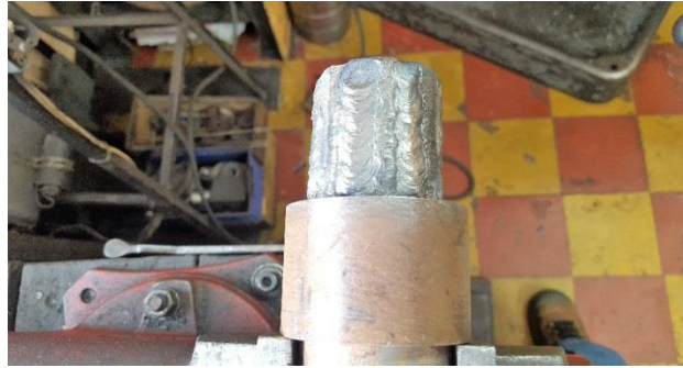
Figura 30. Acabado final de la metalización en caliente
