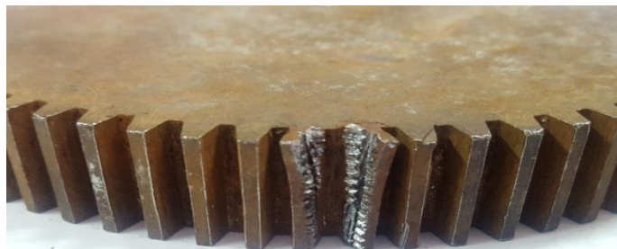
Figura 45. Rueda dentada a reacondicionar por medio de un injerto
