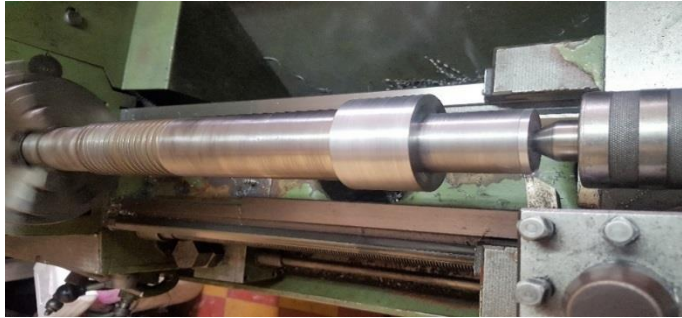
Figura 34. Disminución de diámetro en sección dañada
