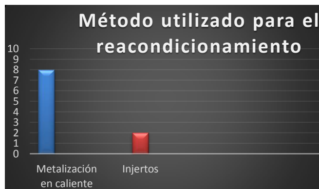
Figura 3. Comparación de métodos utilizados para el reacondicionamiento de ruedas dentadas y ejes
