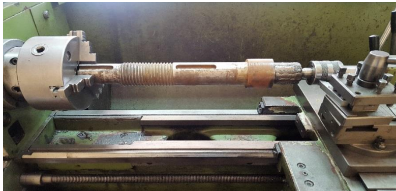
Figura 31. Montaje de eje para su rectificación
