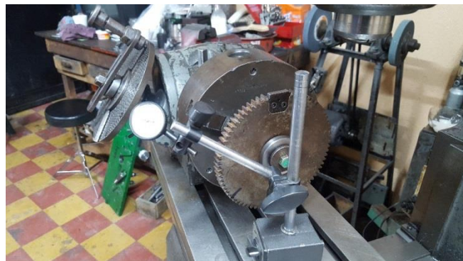
Figura 48. Montaje de rueda dentada a cabezal divisor
