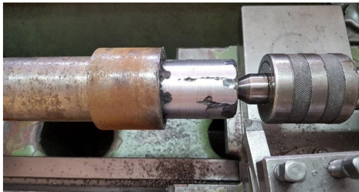
Figura 32. Rectificado de soldadura
