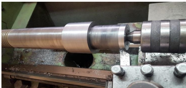
Figura 38. Rectificación y ajuste de diámetro mayor del eje
