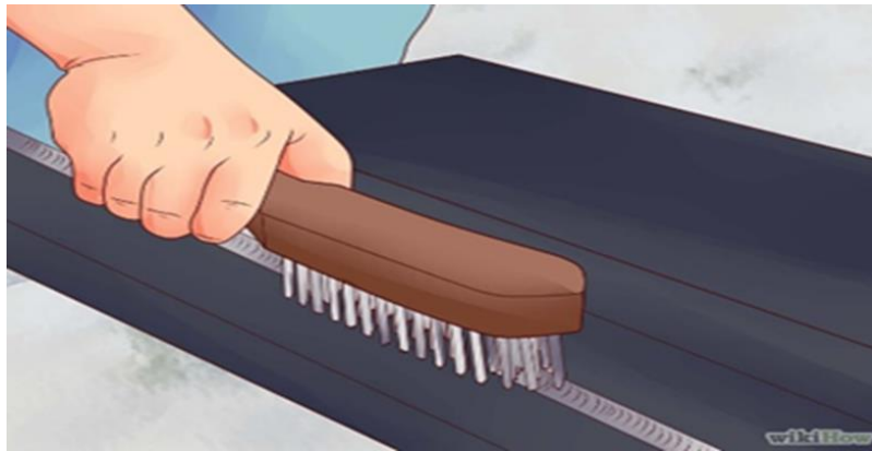
Figura 5. Limpieza de superficie para la remoción de escoria e impurezas
