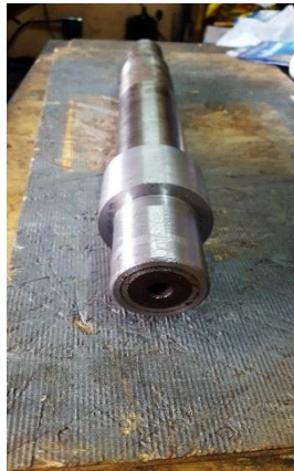
Figura 39. Eje reacondicionado por medio de aplicación de injerto
