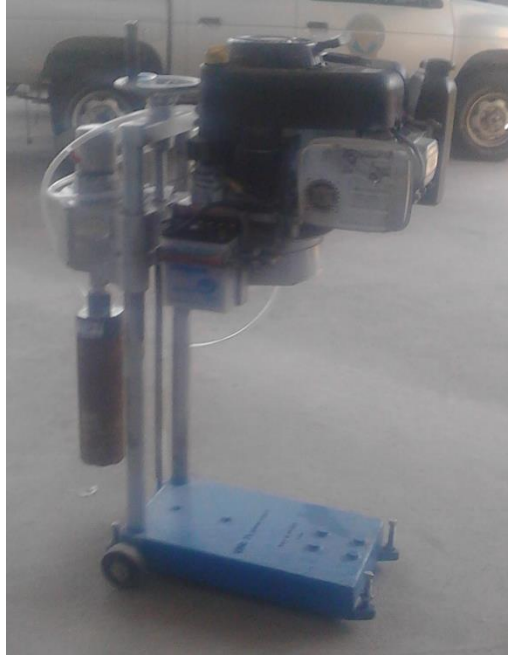
Figura 36. Extractora de núcleos utilizada en el bulevar universitario
