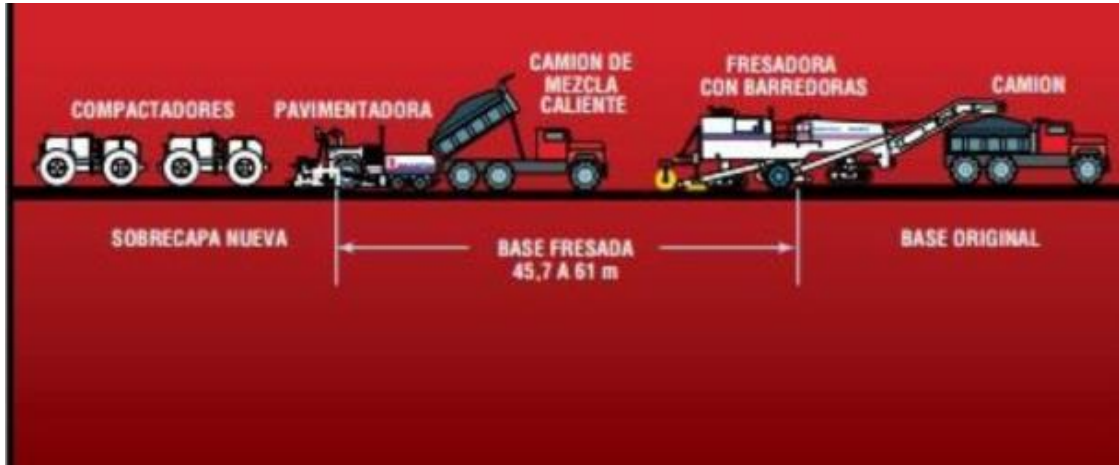
Figura 39. Pavimentación con fresadora y pavimentadora
