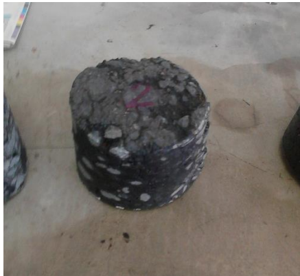
Figura 44. Briqueta núm. 2 extraída del pavimento de la Universidad de San Carlos de Guatemala
