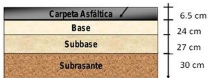
Figura 49. Sección transversal del pavimento universitario
