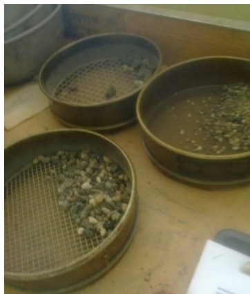
Figura 13. Tamaño de las partículas de un suelo, a través de tamizado
