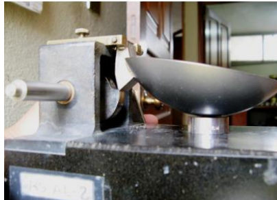
Figura 17. Detalle del talón del aparato de Casagrande al ser calibrado
