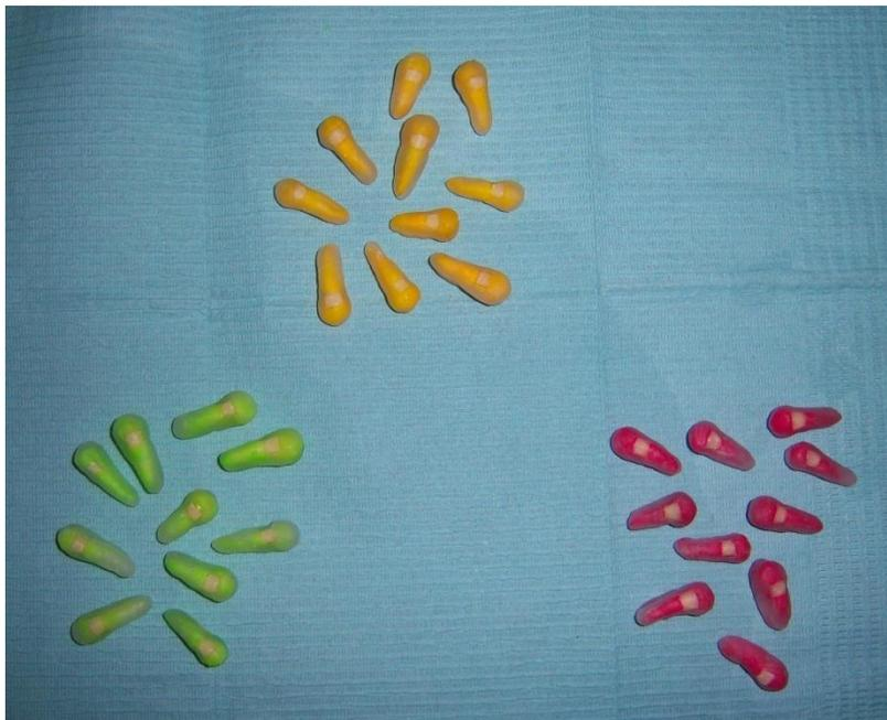
**Las 30 muestras con cera pegajosa y sus colores respectivos identificando al sistema adhesivo utilizado en este estudio previo a ser colocadas dentro del Kitasato con eosina al 2%.**
