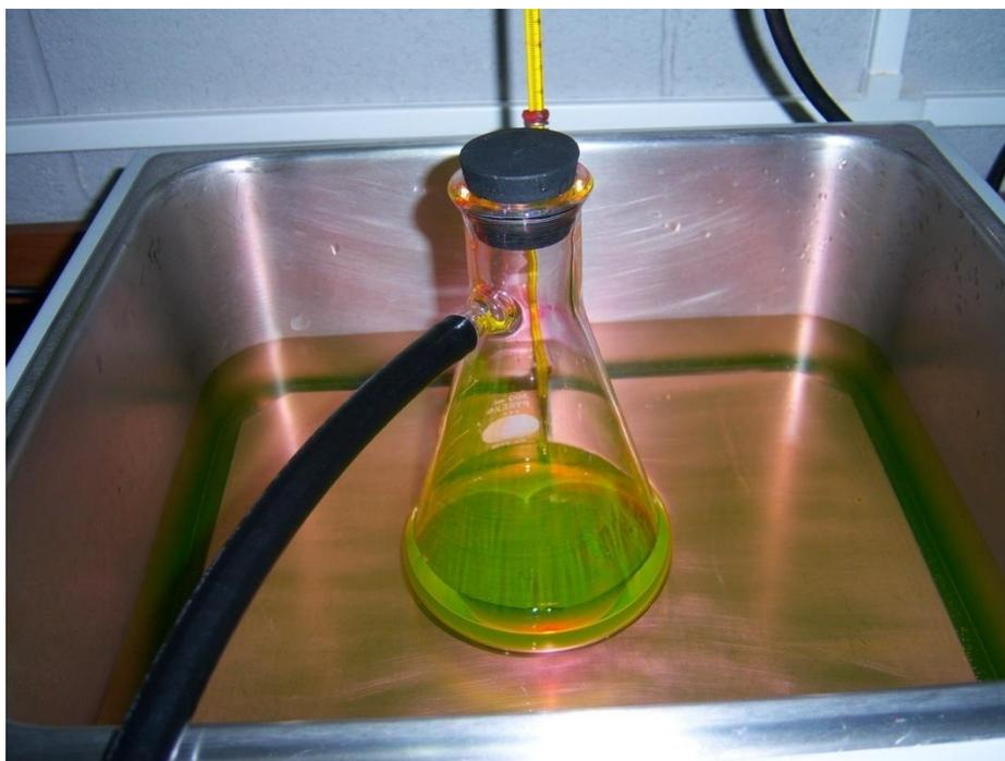
**Se tapó el Kitasato y se conectó a la bomba de vacío durante 30 minutos a temperatura de 37° C.**
