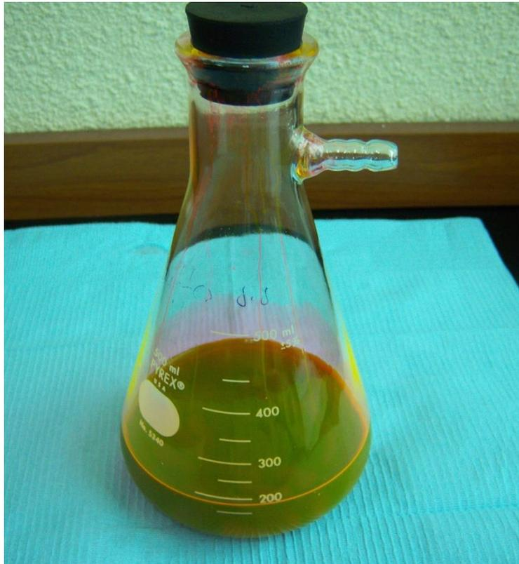
**Pasados los 30 minutos el Kitasato se retiró del baño de María y se eliminó el vacío. Se dejaron las muestras dentro del frasco durante 24 horas para lograr la penetración pasiva de la eosina al 2%.**
