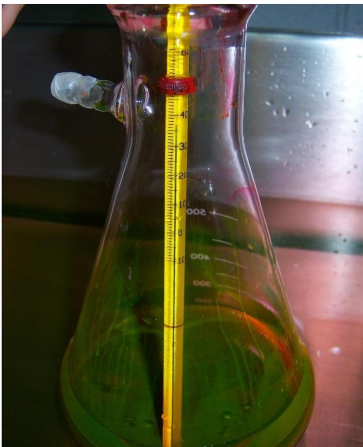
**Termómetro dentro del Kitasato indicando que las muestras se encuentran a una temperatura de 37° C.**
