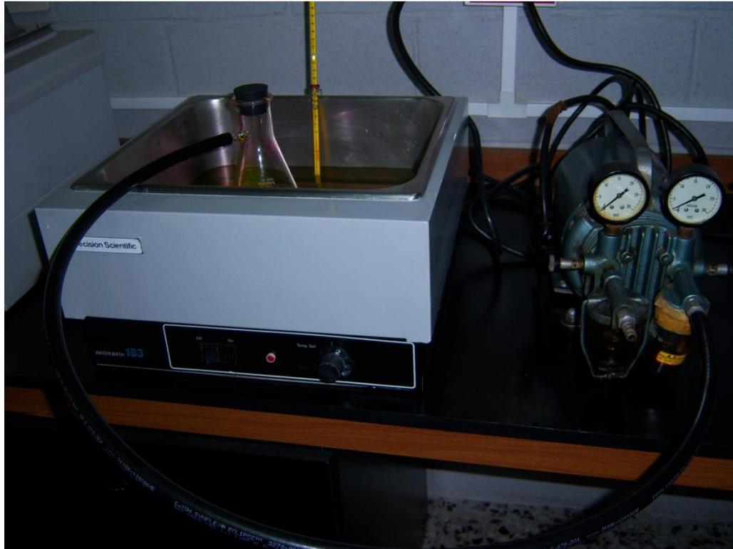
**Kitasato conectado a la bomba de vacío dentro del baño de María**
