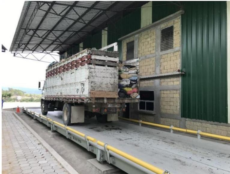
Figura 2.23 Fotografía del pesaje del camión recolector de residuos sólidos en báscula perteneciente al beneficio de café húmedo El Cascajal
