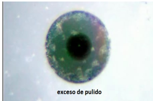
Figura 16. Forma Incorrecta vista desde microscopio para conector de fibra óptica
