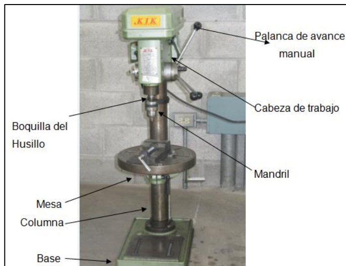
Figura 45. Partes del taladro
