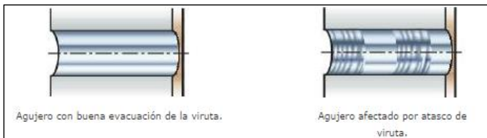
Figura 50. Efecto de la viruta en el taladrado
