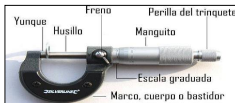
Figura 9. Partes del micrómetro
