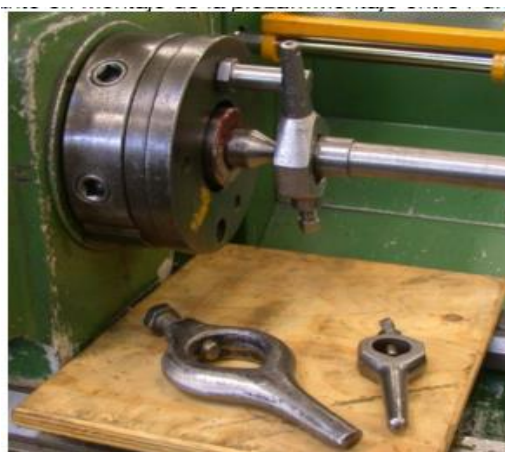
Figura 36. Brida montaje de la pieza entre puntos
