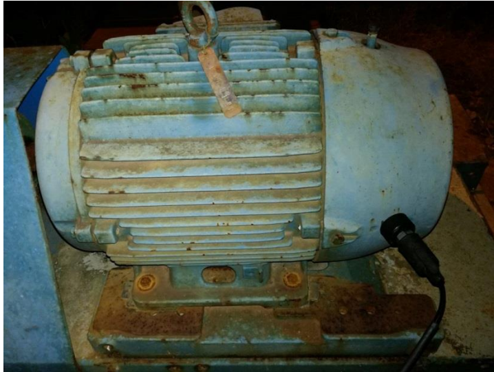
Figura 8. Colocación incorrecta del sensor, en guarda de seguridad
