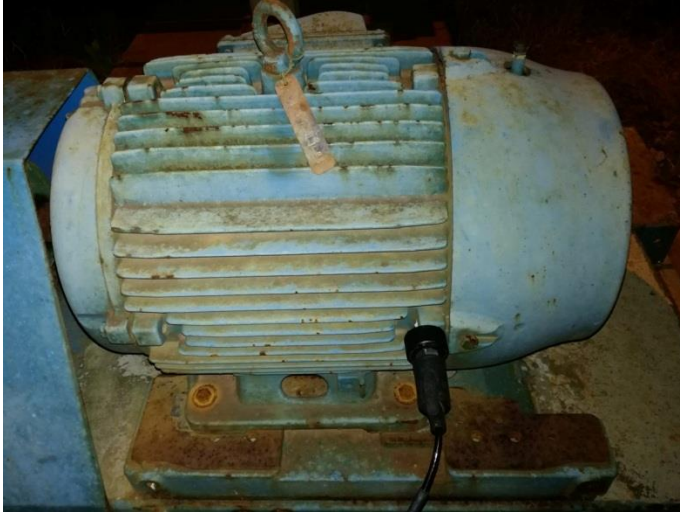
Figura 6. Colocación correcta del sensor, punto 1 horizontal
