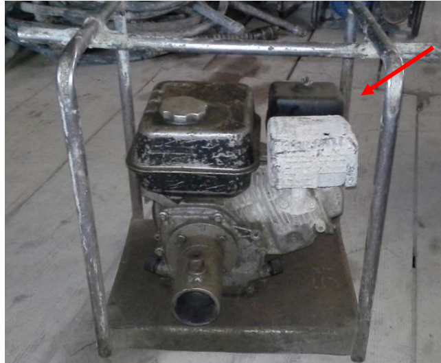
Figura 69. Ubicación del filtro de aire
