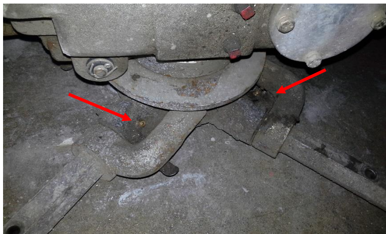
Figura 53. Puntos de engrase de los brazos de las aspas
