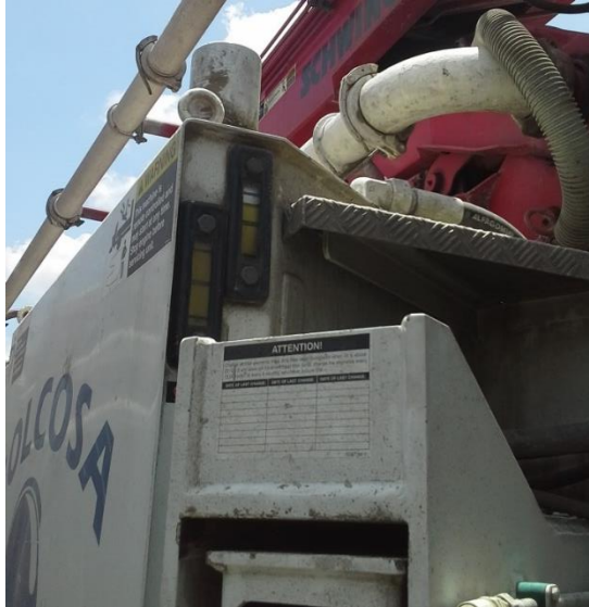
Figura 28. Nivel de aceite del tanque hidráulico
