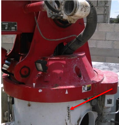
Figura 39. Puntos de engrase del giro de la torre
