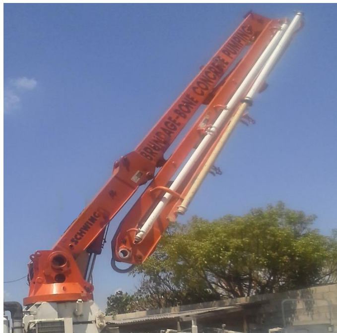
Figura 16. Pluma de distribución
