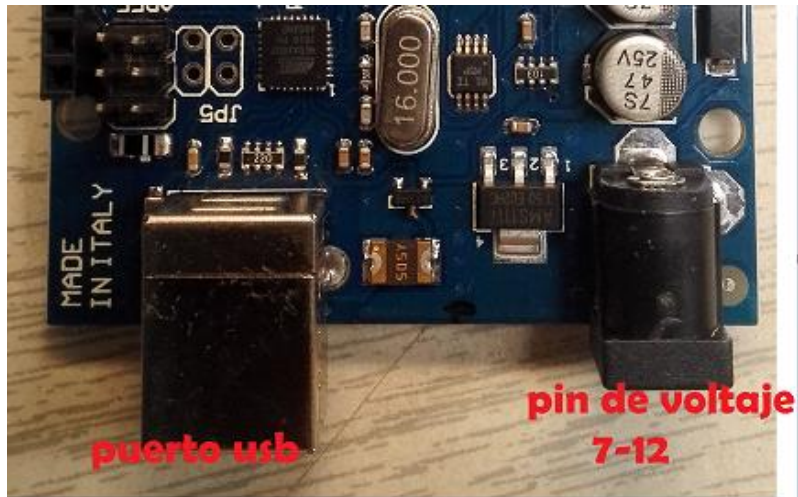
Figura 20. Entradas de alimentación Arduino
