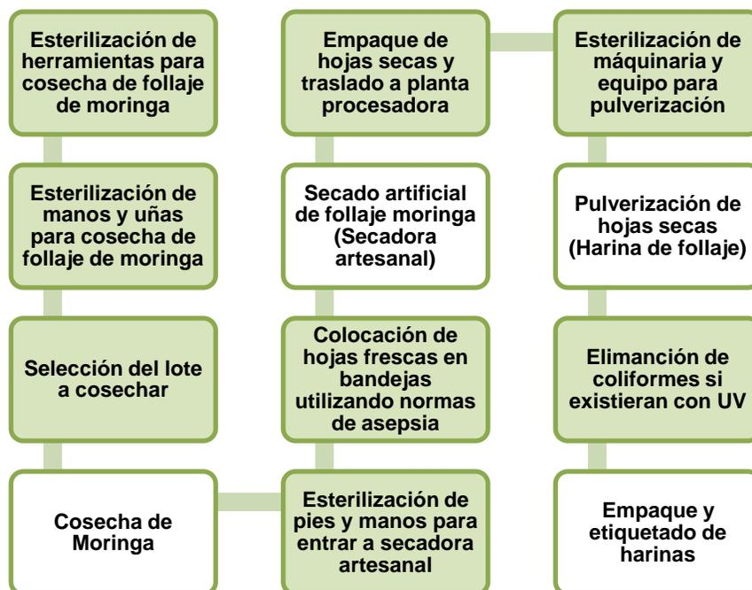
Figura 3-9 Proceso propuesto para la industrialización del follaje de moringa
