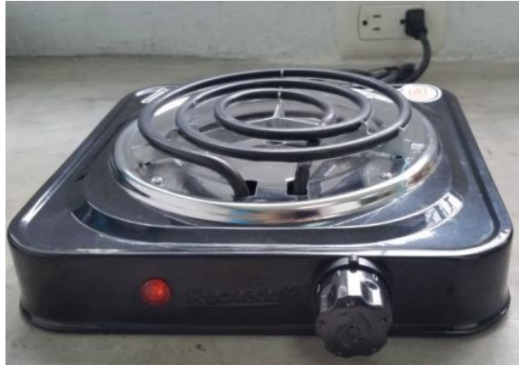
Figura 15. Estufa utilizada para calentar la mezcla asfáltica
