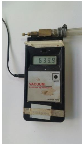
Figura 22. Manómetro de presión residual con válvula de purga
