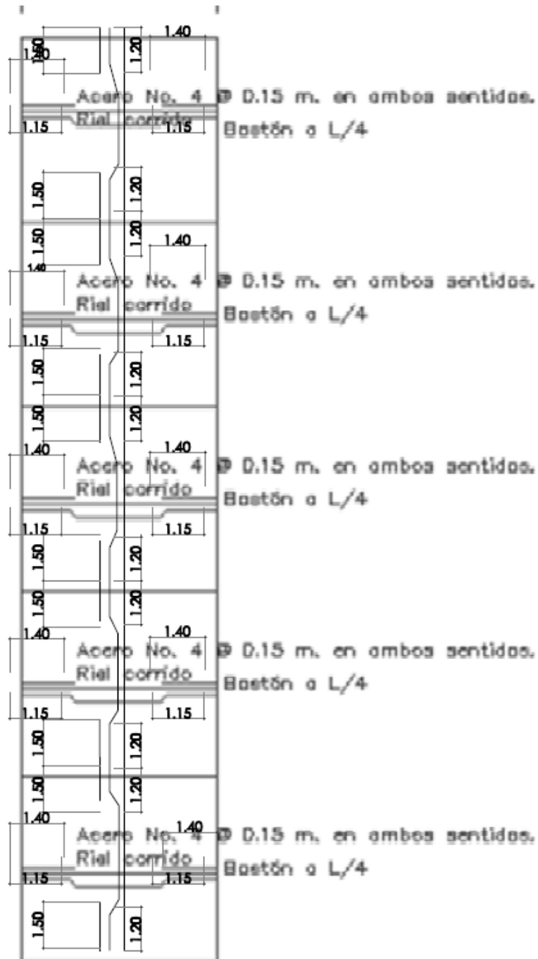
Figura 26. Armado de losas balanceadas
