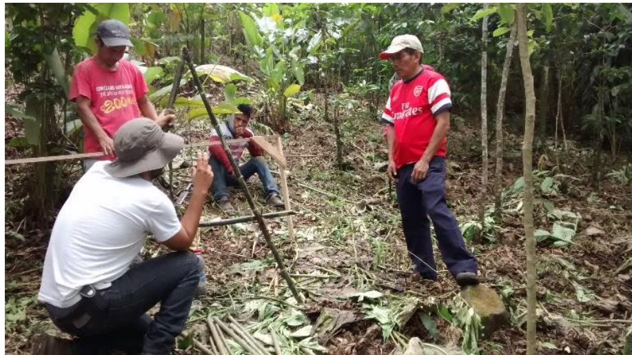
Figura 62. Capacitación del uso del nivel en "A", caserío Pasac
