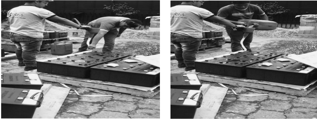
Figura 118. Riesgo de derrames y contaminación de piel por método actual
