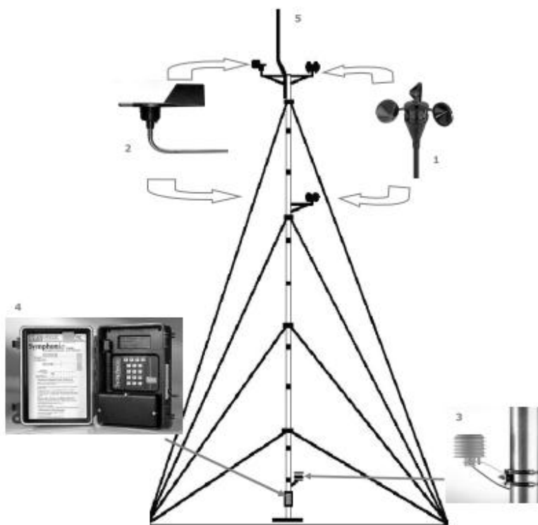
Figura 28. Torre de medición eólica y sus componentes
