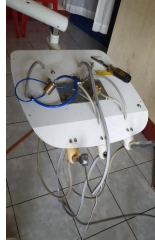
Figura No. 11. Colocación de manguera nueva de pieza de alta velocidad.
