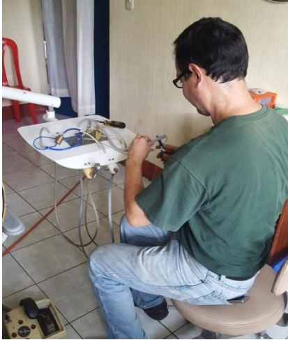
Figura No. 10. Arreglo de succión unidad dental.
