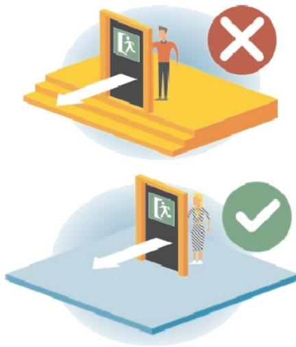
Las puertas en Salidas de Emergencia deberán ser del tipo de pivote o con bisagras, las cuales deberán abrirse en la dirección del flujo de salida durante la emergencia. Las puertas deberán poder ser abiertas desde el interior sin necesitar ningún tipo de llave, conocimiento o esfuerzo especial.
