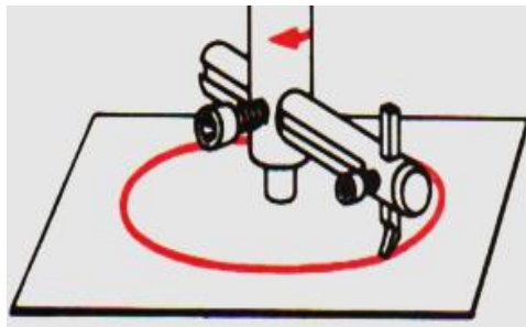
Figura 52. Cuchilla de recortar
