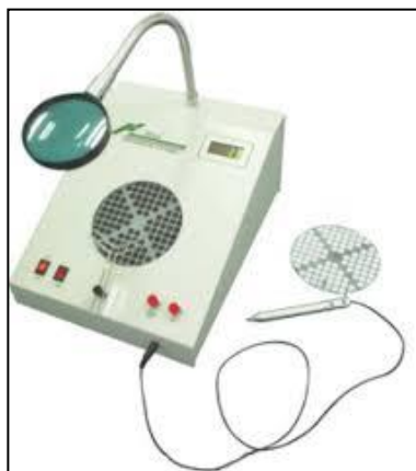
Figura 14. Contador de colonias, utilizado para aumentar vista y realizar conteo de crecimiento de colonias en placas Petrifilm
