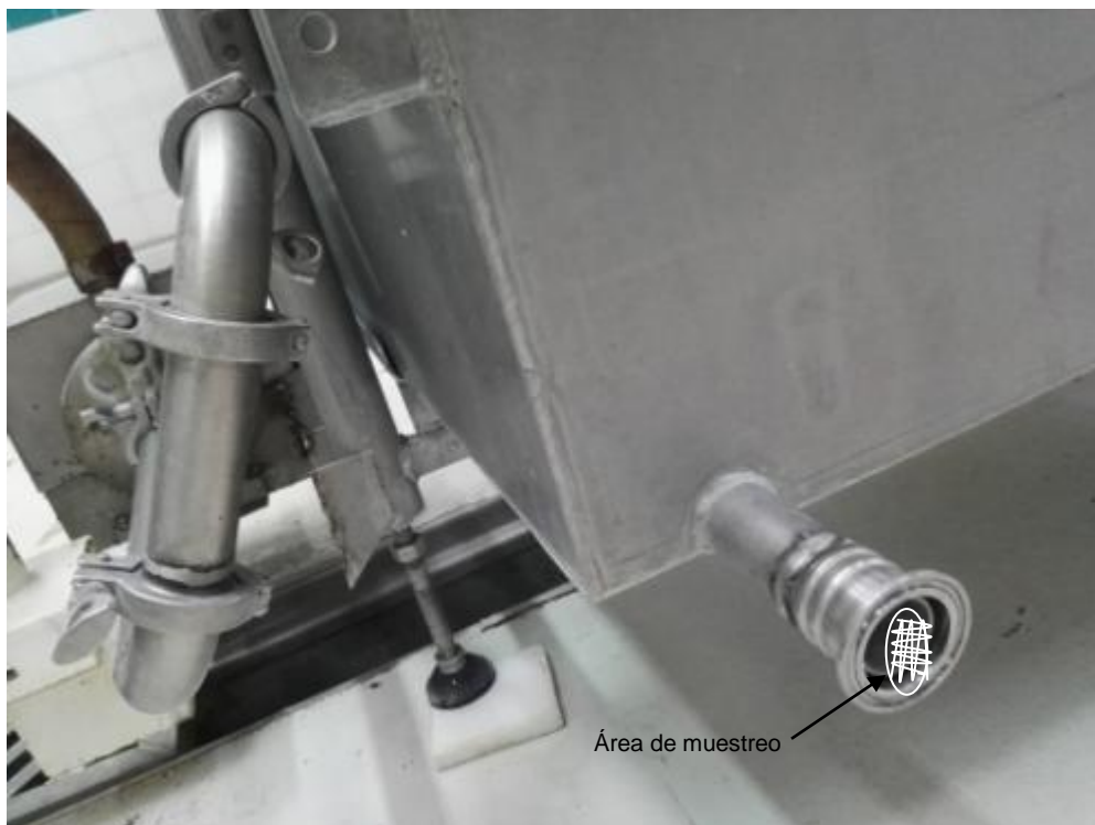
Figura 39. Manguera de almíbar, utilizada para recircular almíbar al tanque de preparación
