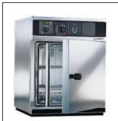
Figura 7. Incubadora para incubar enlatados para análisis, productos y placas Petrifilm a 34\pm 1 °C
