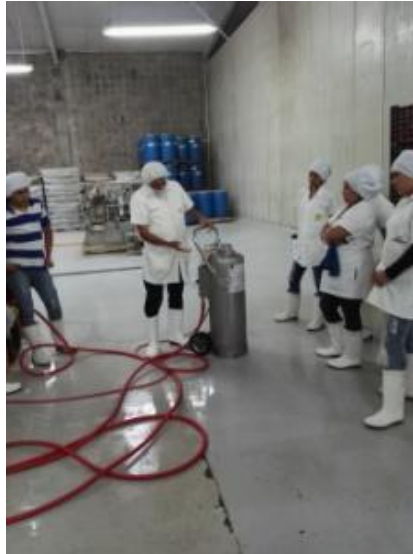
Figura 71. Explicación sobre cómo utilizar una espumadora de jabón, en la capacitación de POES
