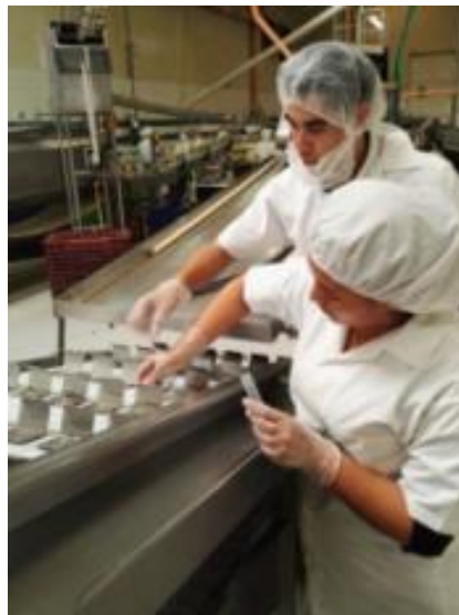
Figura 22. Capacitación a inspectora de calidad sobre muestreo de superficies con hisopos Swab Sampler
