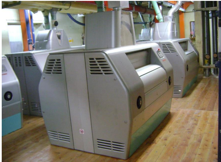
Figura 2. Banco de molienda utilizados para la trituration y compresión
