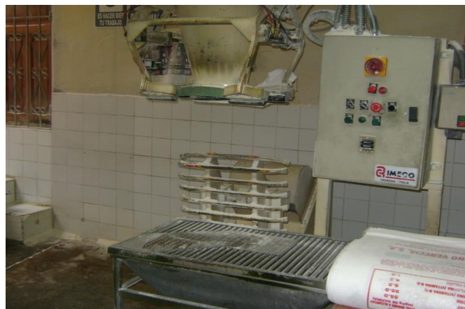
Figura 12. Máquina de ensacado de una boca con sacudidor de sacos
