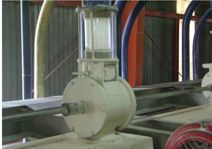
Figura 9. Esclusa utilizada para separar producto de una corriente de aire a presión
