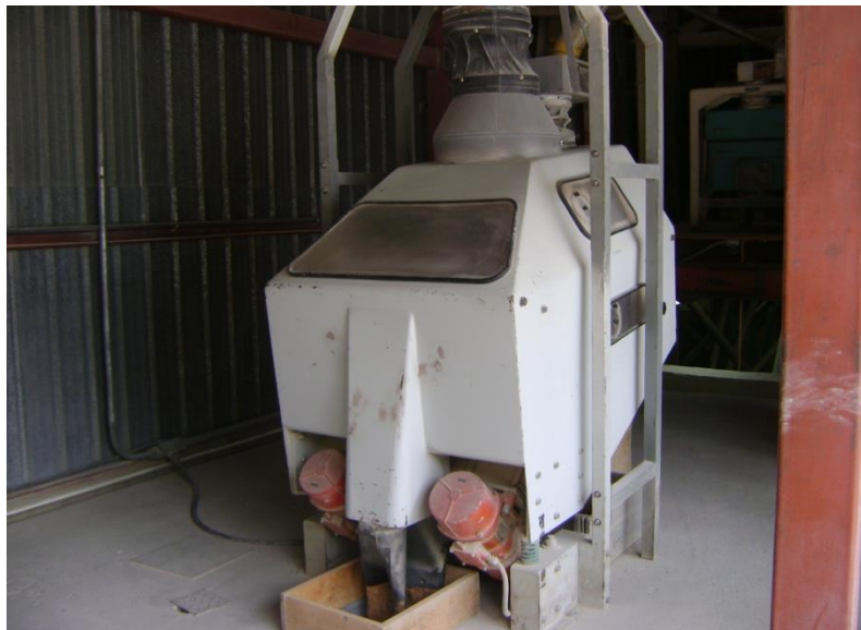
Figura 10. Despedradora gravimétrica y la aplicación en separación de piedras en cereales
