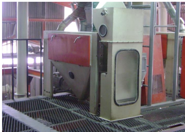
Figura 8. Despuntadora, máquina utilizada en la etapa de limpieza del grano
