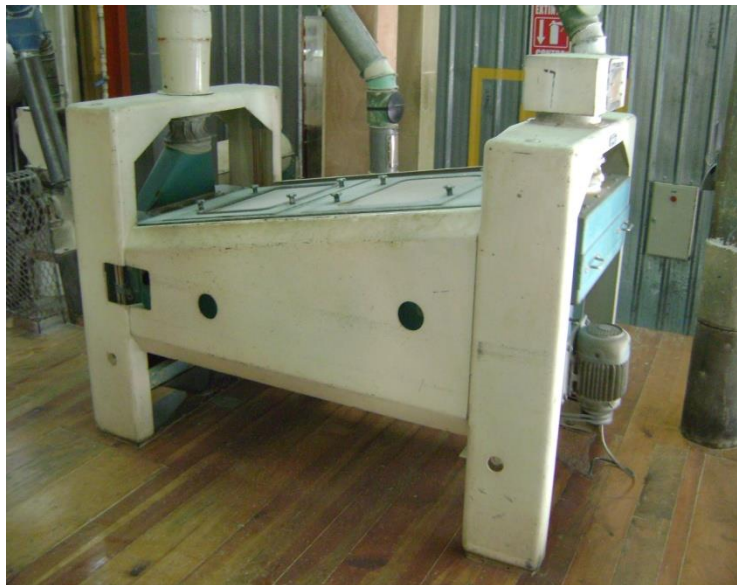
Figura 7. Limpiadoras de granos por medio de cribas metálicas
