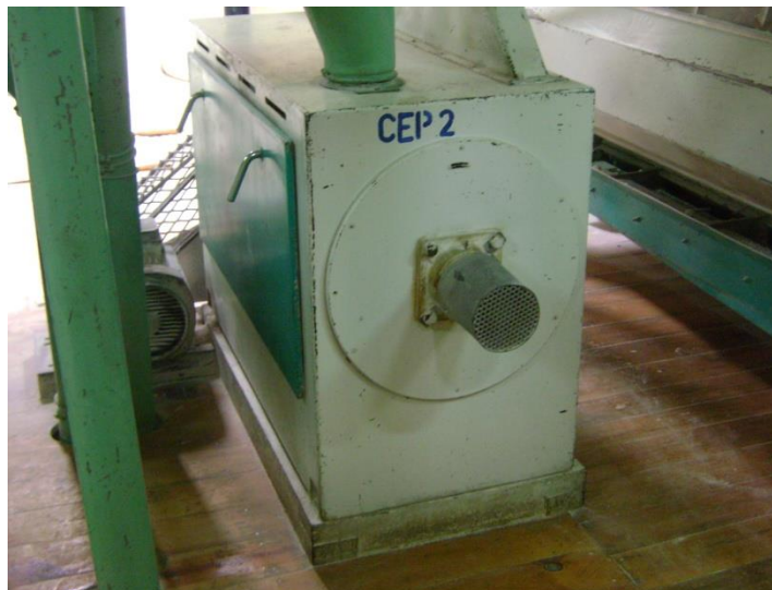
Figura 5. Cepilladora o recuperadora utilizada en el proceso para extraer harina que pudiera contener el afrecho o granillo
