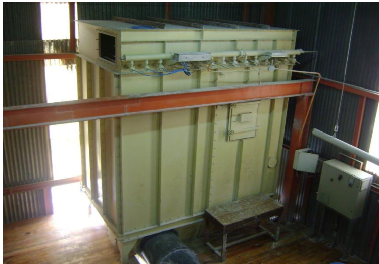
Figura 15. Filtro de mangas a presión para separación de polvo
