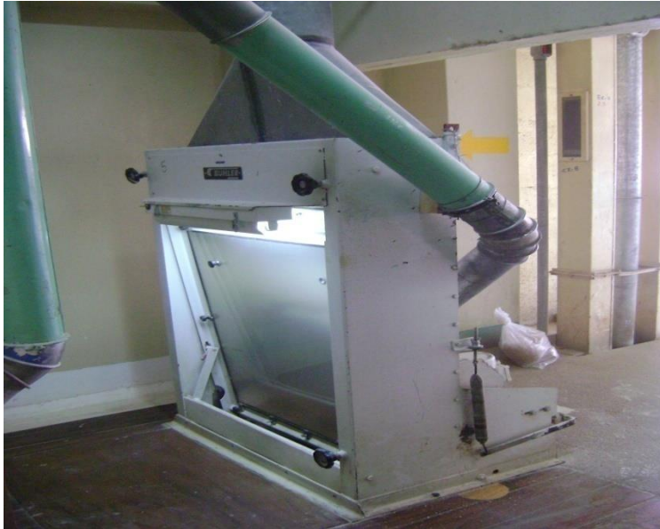
Figura 4. Tarara utilizada para limpieza de trigo
