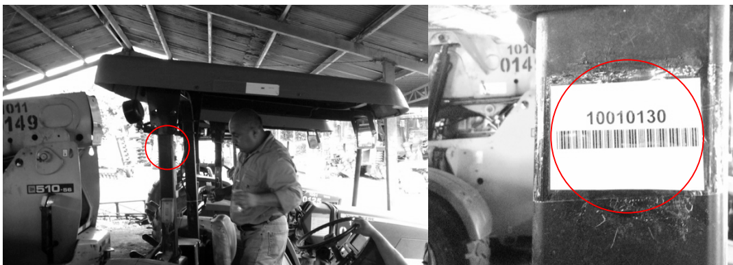
Figura 13. Instalación de chip NFC
