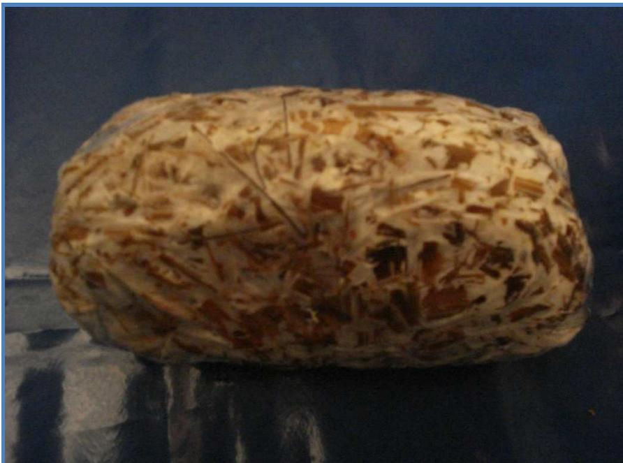
**Figura 5A.** Unidad experimental cubierta completamente por micelio del hongo *P. ostreatus*.
