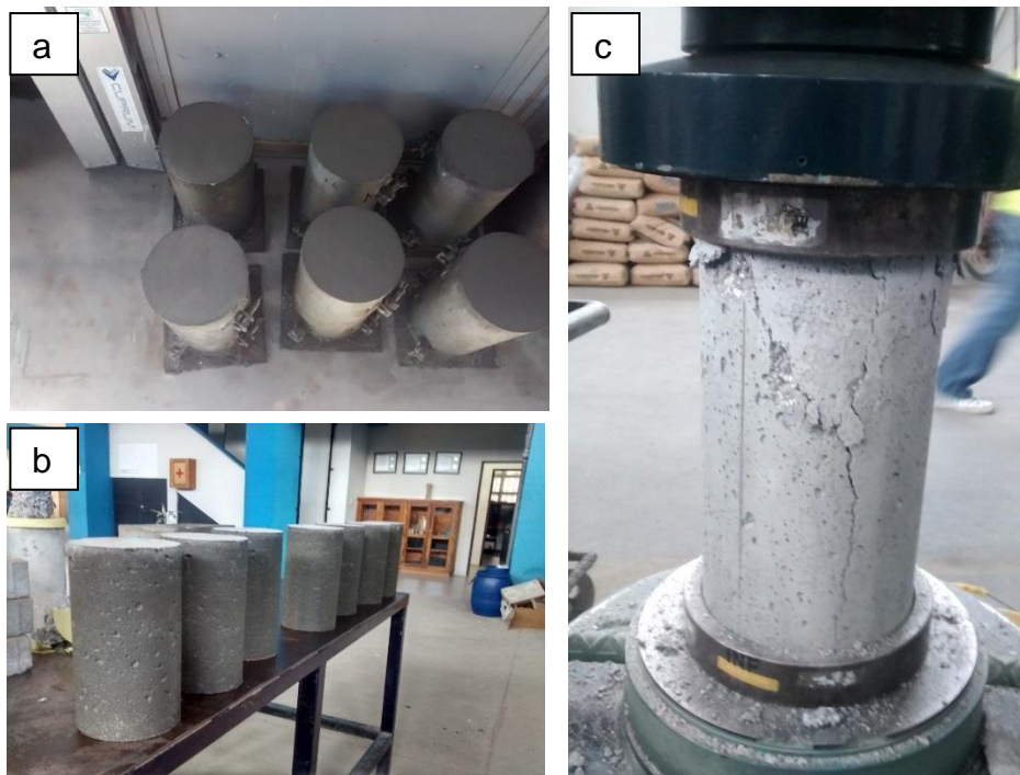
Figura 26. Resistencia a compresión
