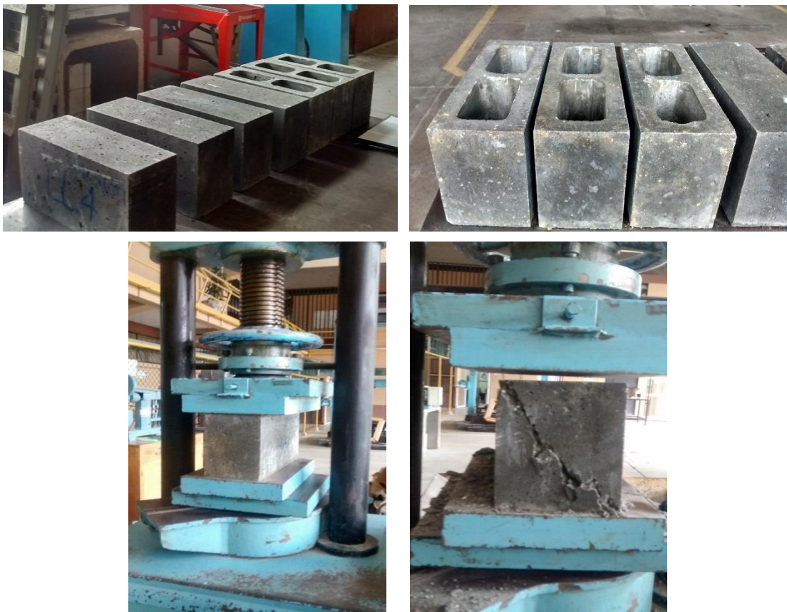
Figura 30. Ensayo a compresión de bloques
