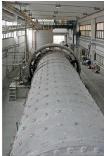
Figura 7. Molino de bolas para granulado de arena
