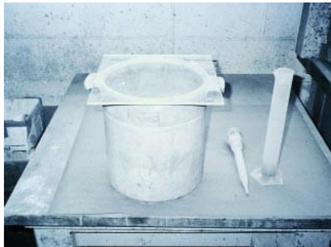
Figura 24. Ensayo de exudación
