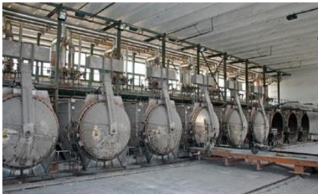
Figura 12. Cámaras de autoclave
