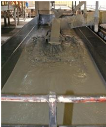
Figura 9. Masa de mezcla vertida en moldes
