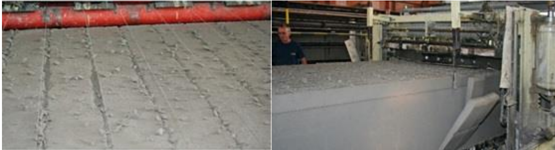
Figura 11. Corte vertical mediante cables tensados
