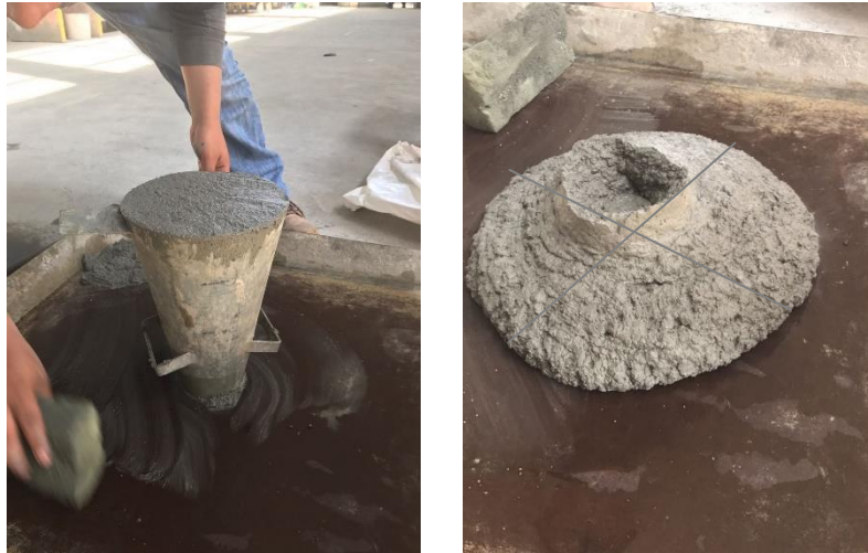
Figura 20. Flujo del asentamiento de concreto celular
