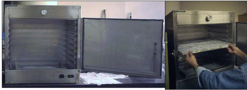
**Figura 13A. Vista interior de cámara de germinación y colocación de bandejas.**
