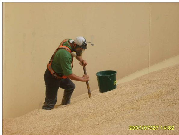
**Figura 3. Toma de muestra superficial de malta con sonda de alveolos en bodega de buque granelero.**
