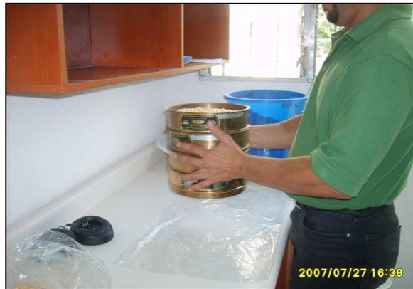
**Figura 4. Procesamiento de muestra utilizando tamices de distintos mesh.**
