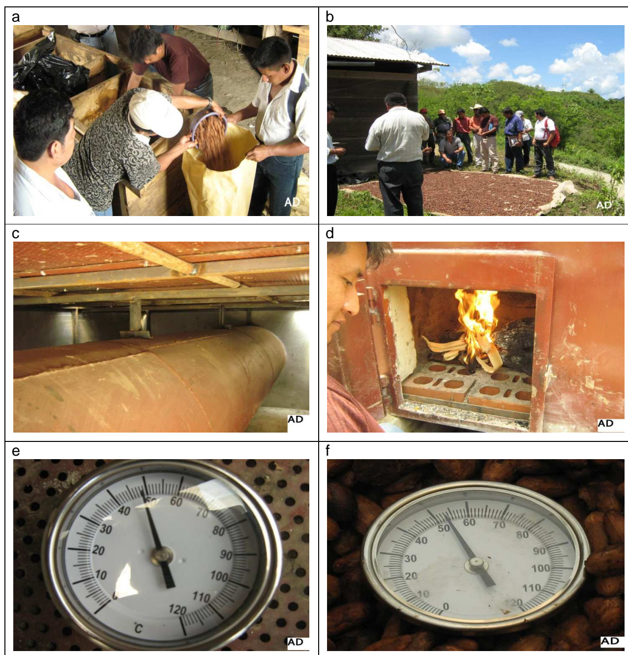
Figura 23 Pasos para el secado del cacao. a) pesado de cacao fermentado. b) secado de cacao al aire libre 2 hrs antes de llevarlo al beneficio. c) verificación y limpieza de parte interna del beneficio. d) encendido del horno de intercambio de calor. e) medición de temperatura antes de encender el horno. f) medición de cacao después de encender el horno y depositar el grano de cacao.
