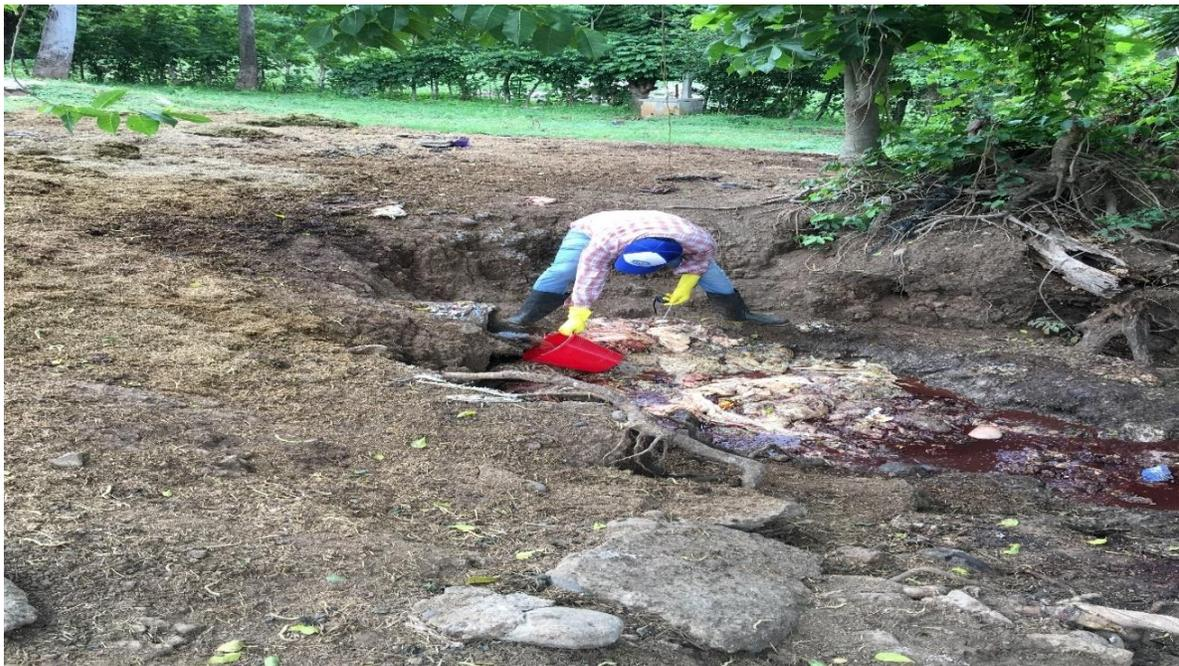
**Figura No. 19** Aforando la descarga del Rastro Municipal
