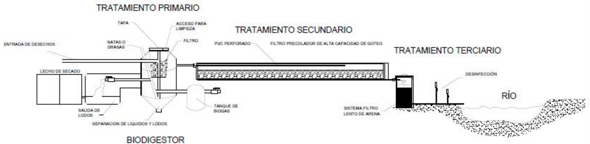
**Figura No. 13** Propuesta del sistema de tratamiento de las aguas residuales generadas en el Rastro Municipal.
