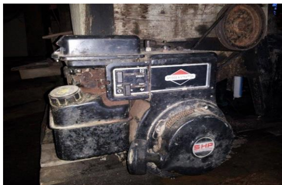
Figura 12. Motor diésel de 5HP marca Briggs &Stratton
