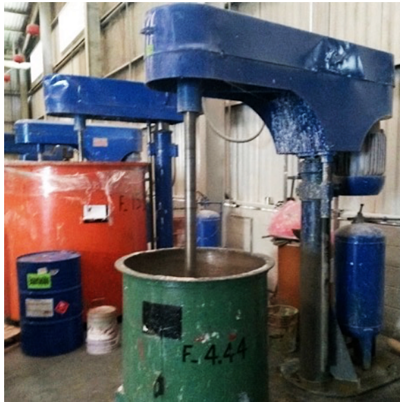
Figura 11. Dispersor de recubrimientos en área de dispersión PBS
