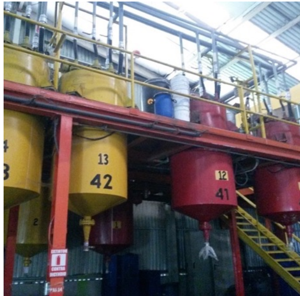
Figura 16. Tanques agitadores en área de refinado de industria PBS
