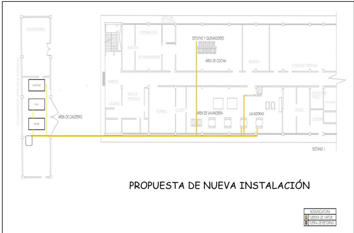
Figura 40. Nueva propuesta de sistema de vapor
