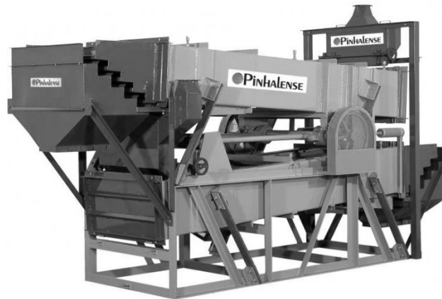
Figura 36. Imagen de una clasificadora de café en oro por tamaño
