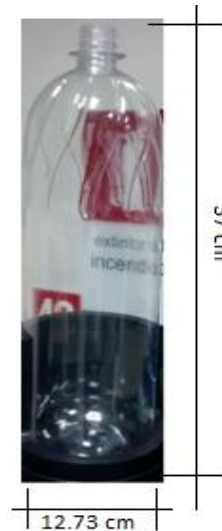
Figura 22. Dimensiones de envase PRB de 2,5 lts
