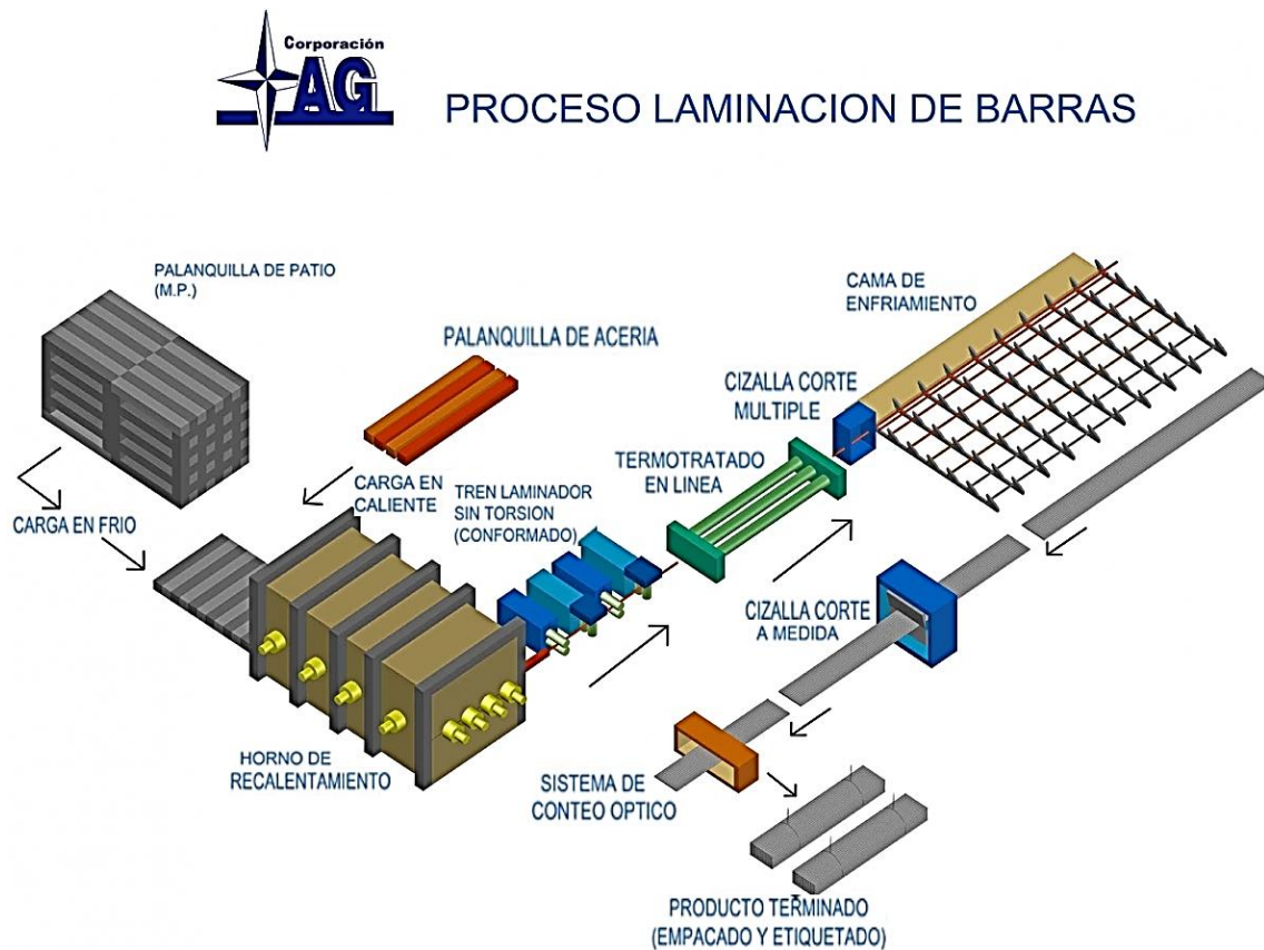
Figura 5. Diagrama de proceso de producción de barras
