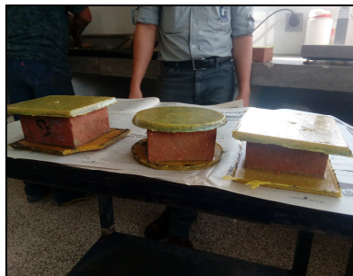
Figura 22. Ladrillos nivelados en su cara de compresión con azufre
