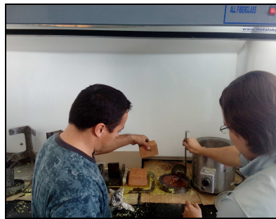
Figura 21. Nivelación de las caras de compresión con azufre
