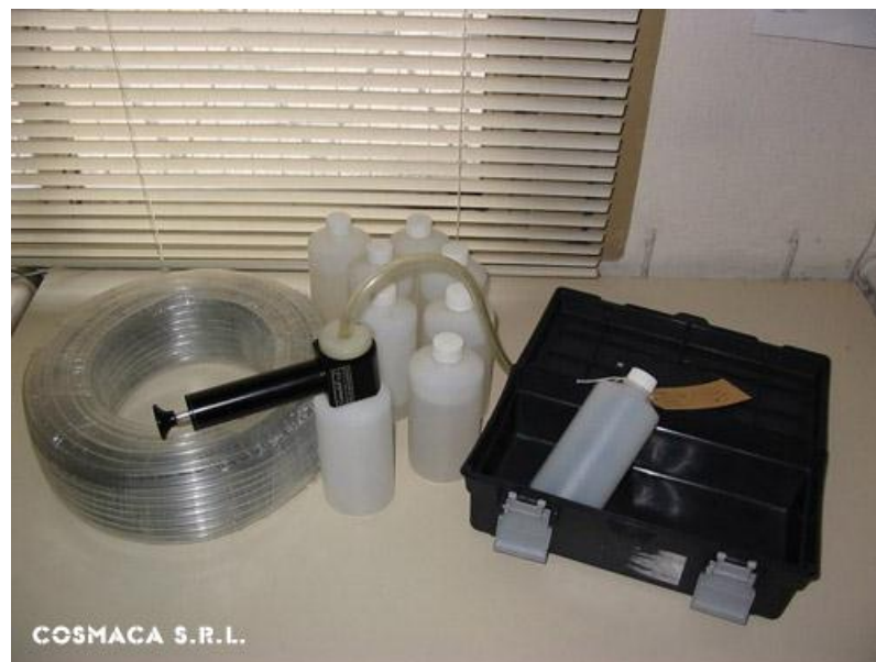
Figura 19. Ejemplo de kit para extracción de muestras de aceite para vehículos
