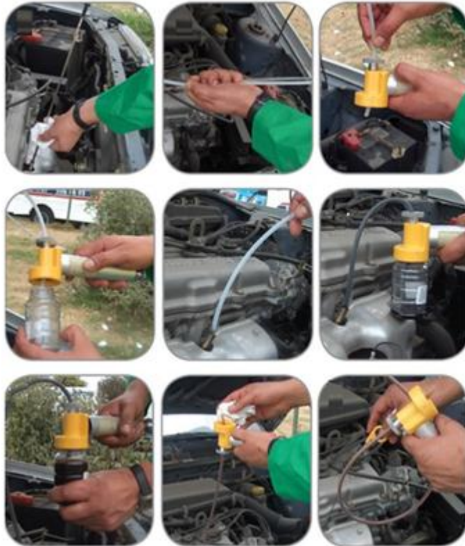
Figura 18. Ejemplificación de los pasos de extracción de una muestra de aceite usado
