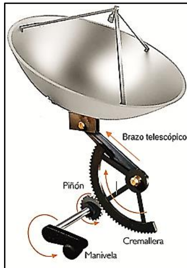
Figura 75. Esquema de soporte inferior
