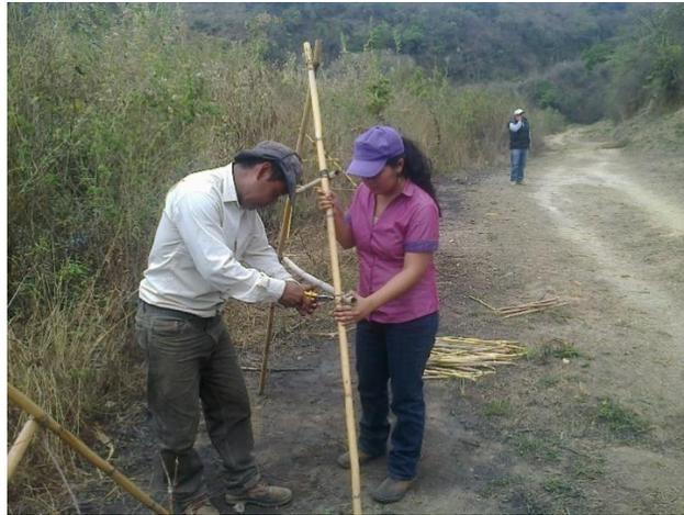
**Figura 41. Preparación de equipo a utilizar: Nivel en "A"**
